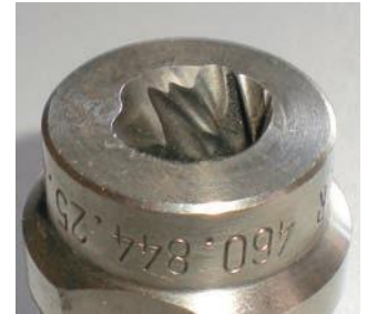
Abb. 2: Verschleiß einer Vollkegeldüse
