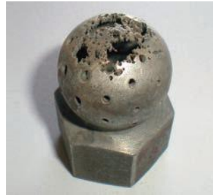
Abb. 1: Chemische Korrosion einer Sprühkugel
